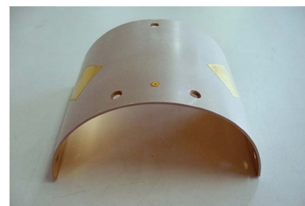
曲面形状フッ素基板（材料から曲面成型）
